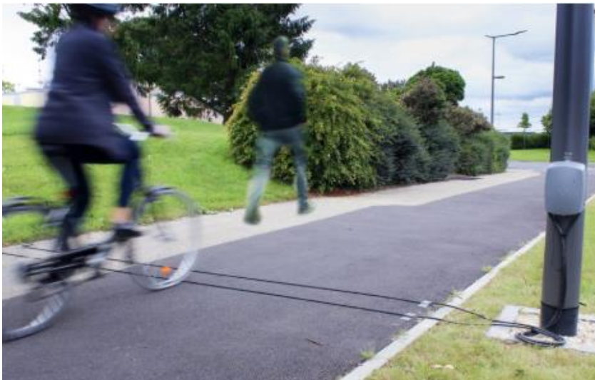
Figur 24. Hastighetsmätning med pneumatiska slangar. Källa: Amparo solutions, 2018 30 .
