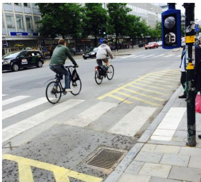
Figur 23. Trafiksignal som indikerar tid för att hinna med i vågen. Källa: Pilotplatsstockholm.se
