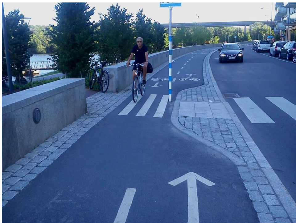
Figur 18. Dubbelriktad cykelbana med avsmalning, inåtvänd klack, som fungerar som en hastighetsdämpande åtgärd. Foto: Krister Isaksson, Bicycling
