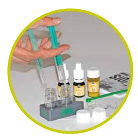
Mit der beigefügten Spritze beide Prüfgläser mit Probewasser füllen.
