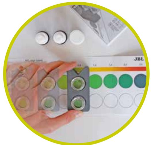
Komparatorblock mit der Einkerbung zu den Werten zeigend mit beiden Prüfgläsern auf der Farbskala hin und her bewegen, bis die Farbe der mit Reagens versetzten Probe der Farbe unter der Blindprobe bestmöglich entspricht.
