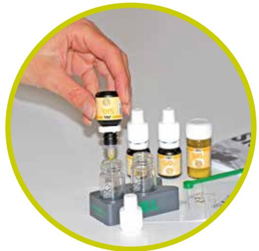
In eines der beiden Prüfgläser die Reagenzien zugeben.
