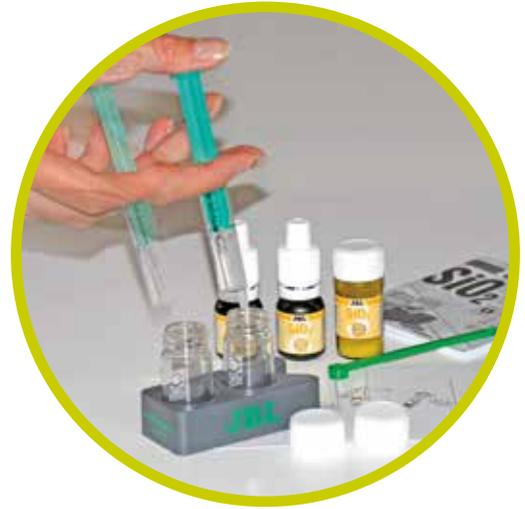
Mit der beigegefügten Spritze beide Prüfgläser mit Probewasser füllen.
