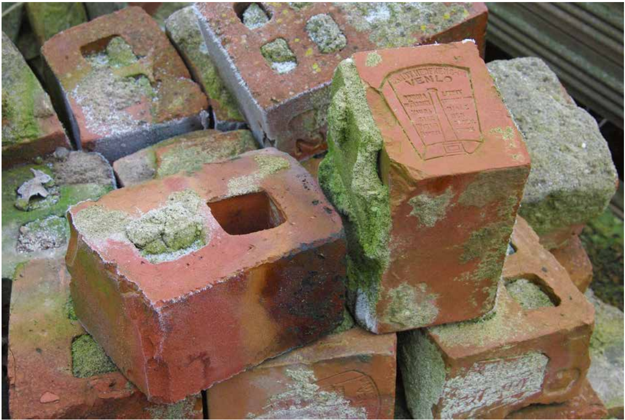
Afb. 39 Holle radiaalstenen met het fabrieksmerk van de firma Canoy-Herfkens te Venlo op het terrein van steenfabriek De Werklust te Losser, afkomstig van een onbekende afgebroken fabrieks- schoorsteen.
