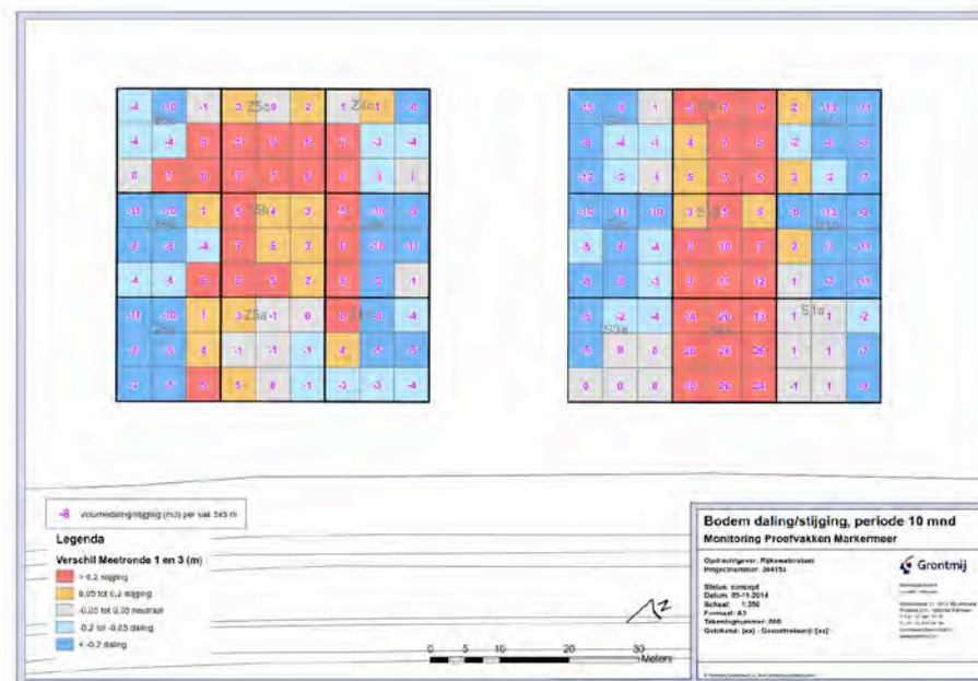
Figuur 3.5 Verschilmeting bodemligging. Blauw is daling van de bodem, rood is stijging van de bodem en grijs is gelijkblijvende bodem. De daling en stijging zouden in relatie gezien moeten worden met de zettingen van de ondergrond (zie §3.5.2). De zettingsmetingen zijn niet geheel betrouwbaar (zie §3.5.1) waardoor bij de interpretatie van de bodemligging in dit rapport hiermee slechts beperkt rekening is gehouden.
