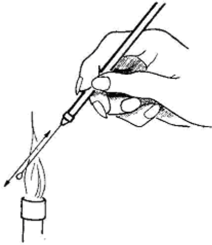
Figuur 101. Het flamberen van een entnaald.
