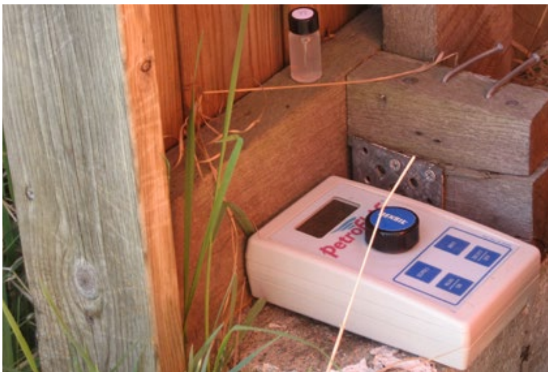
PetroFlag för analys av tyngre petroleumkolväten i fält.
