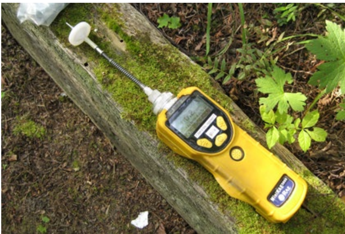
PID-instrument för mätning av flyktiga kolväten i fält.
