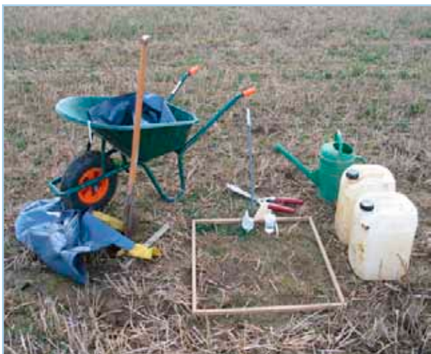
Figuur 3. Overzicht van de benodigde materialen om regenwormen op kwantitatieve wijze te bemonsteren: houten kader om proefvlak af te bakenen ( 0,71 \times 0,71 \text{ m}^2 ), schaar om vegetatie zo kort mogelijk tegen het bodemoppervlak te verwijderen, jerrycans met extractievloeistof (mosterdpoeder in watersuspensie), gieter om mosterdsuspensie gelijkmatig over het proefvlak uit te gieten, spade en gelabelde plastic zak voor bodemstaalname, afsluitbare gelabelde recipiënten gevuld met ethanol (70 %) om regenwormen in te verzamelen, en een kruiwagen voor vervoer van stalen en jerrycans.
